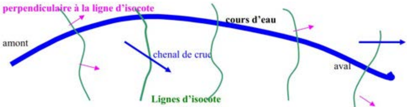
Sens d'écoulement des eaux : emprise de la ligne d'eau selon l'angle du bâtiment (exemples)
