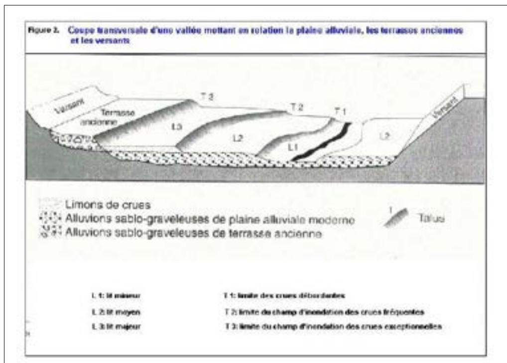
Figure n° 11 : coupe type que l'on peut retrouver sur le terrain, dans le cas notamment dans les bassins de la Garonne (d'après le guide méthodologique P.P.R.)
