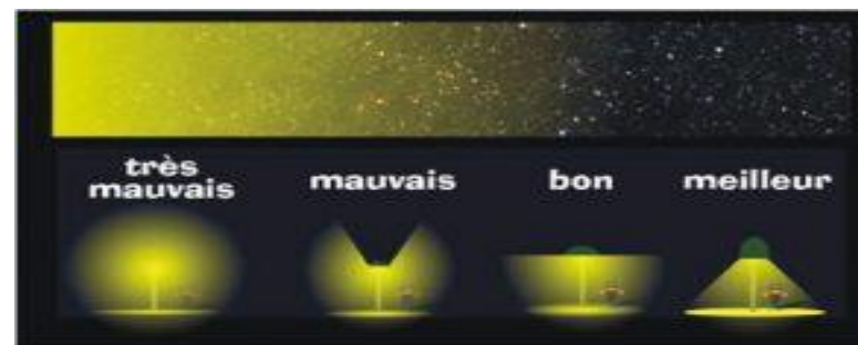
Figure 7. Exemple de panneau avertissant de l'extinction nocturne de l'éclairage public sur une commune (photo : MREnvironnement, 2025) ; Schéma de l'adaptation des dispositifs d'éclairage pour les chauves-souris (source : région Occitanie).
