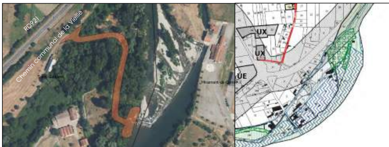
Figure 16. Tracé de l'accès envisagé pour le chantier de la passe à poissons (source : ISL Ingénierie, mars 2023) et zonage correspondant dans le PLU.
