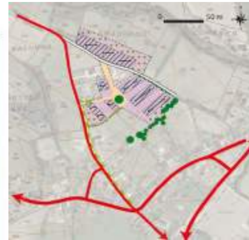
Latouze Bourg Développement urbain à flanc de colline en suivant les courbes de niveau
