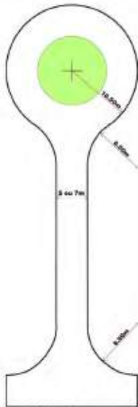
Figure 1 - Principe de retournement de type « raquette » de type « en T »
